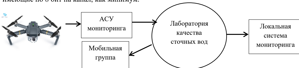
Рис. 2. Блок-схема импактного мониторинга с БПЛА.
